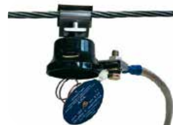
ASA surge arrester with disconnector after MO-blocks have been damaged Überspannungsableiter Typ ASA mit einer Trennvorrichtung nach dem Auslösen (beschädigter Varistor)
