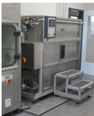
Nossa bacia de imersão para verificar se nossos produtos garantem a especificação da classe de proteção IPX7.
